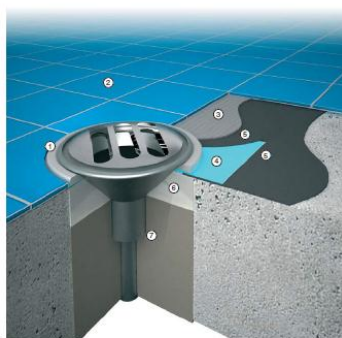
Схема применения материалов PCI при установке закладной на дне бассейна
