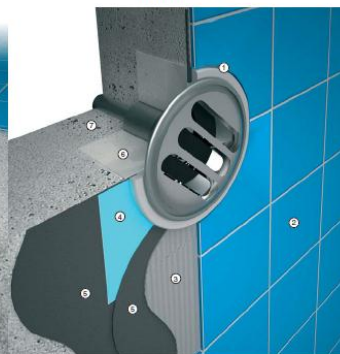
Схема применения материалов PCI при установке закладной в стене бассейна
